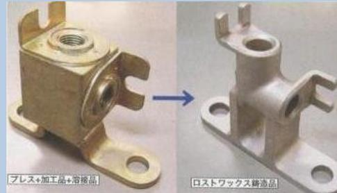
ロストワックス(精密鑄造法)による複合部品の一体化
