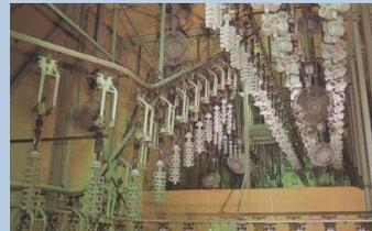
ツリーに多数のワックスパターンが取付可能・コンベアシステムにより連続自動運転可能 等
