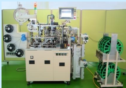
素子検査選別テーピング装置
