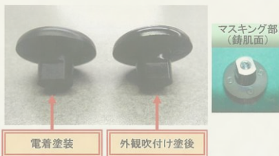
商品例2: 電着塗装上にマスクをし、吹付け塗装したもの
