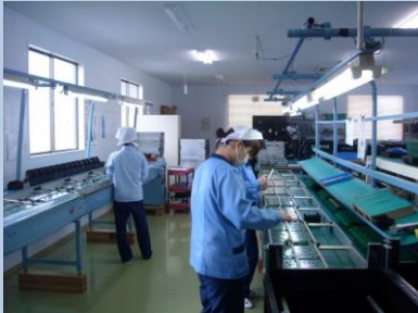
基盤挿入ライン
