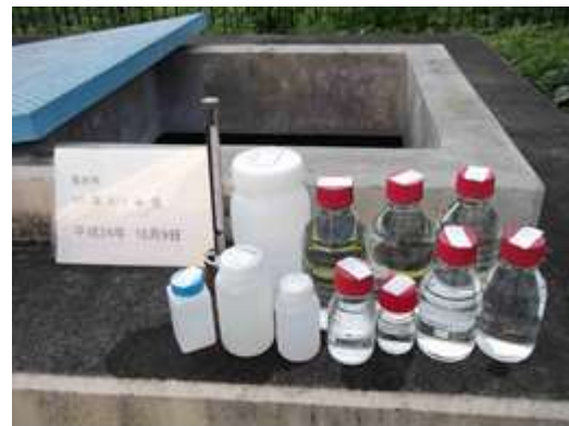
原水採水状況（水源地）
