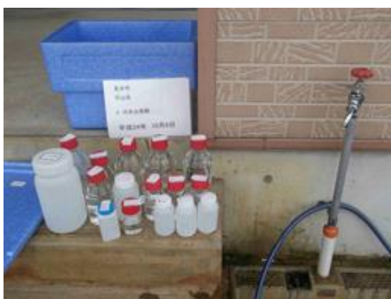
浄水採水状況（蛇口）
