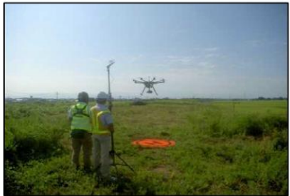
UAVIによる施工前の空中写真測量
