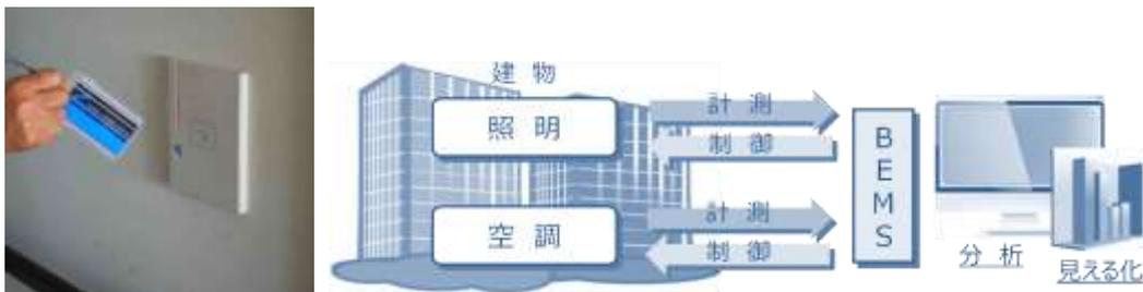
ICカードによる入室管理・BEMSによる効率的な施設運用管理システム
